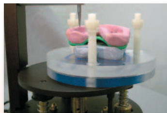
Esecuzione dei fori con la foragessi DVA
