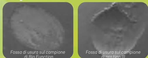
La surface d'usure d'Ena HRi Bio Function et Gold Type III. La morphologie du puits d'usure est très similaire.
